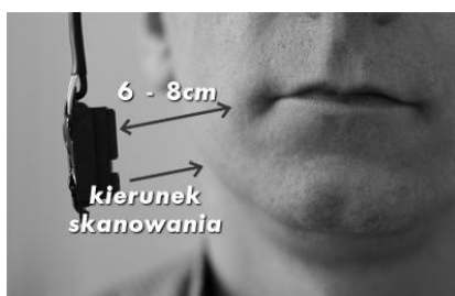
Rys. 4. Przykład czujnika zamontowanego w pobliżu ust
